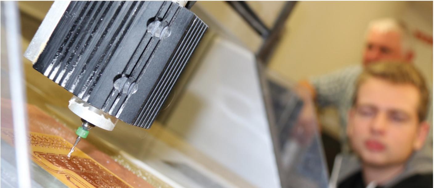
Die von Studierenden entwickelten Platinen-Layouts werden mit den, den aktuellen Industriestandard entsprechenden, CAD- und CAM-Formaten bearbeitet und können mit dem CNC-Fräse-Bohr-Plotter oder nach dem photochemischen Verfahren gefertigt werden.
