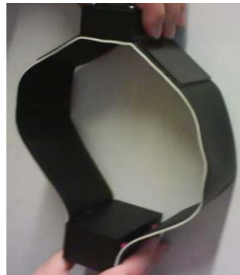
Das GPS-Halsband wurde vom Studienbereich Systems Engineering entwickelt und ist in seinen Hardware-Kosten deutlich günstiger als kommerzielle Lösungen.
