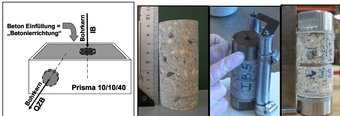
Abbildung 1: links: Entnahmerichtung und Bezeichnungen der Bohrkern: IB....in Betonierichtung, QZB.... Quer zur Betonierichtung rechts: Probekörperansichten und Probekörpervorbereitung (Zentrieren und Kleben der Adapter)
