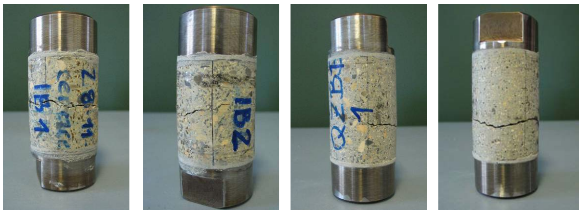
Abbildung 4: Beispiele für ungekerbte Probekörper nach dem Versuch
