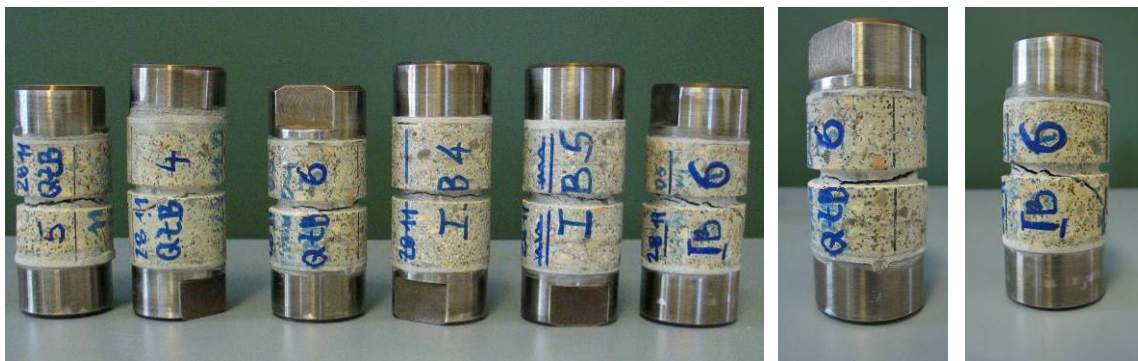
Abbildung 6: gekerbte Probekörper nach dem Versuch
