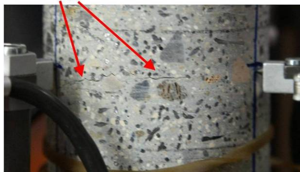
Abbildung 3: Ungekerbter Probekörper, Detail Rissausbildung
