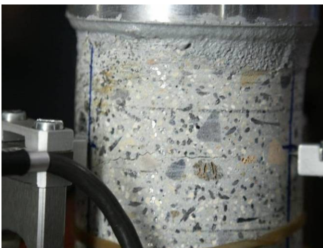
Rissdetail, ungekerbter Probekörper
