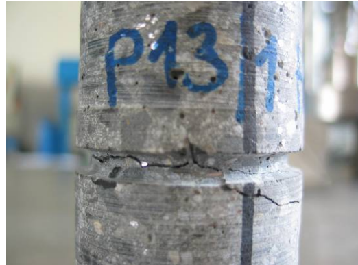
Detail gerissener Probekörper
